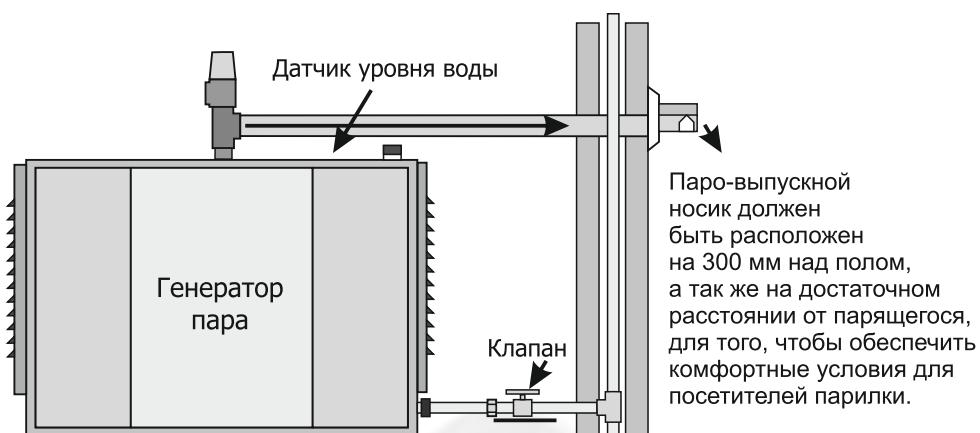
Для отвода пара необходимо подсоединить медную трубку соответствующего диаметра (1/2- для парогенераторов 4-6 Квт, или 3/4- для парогенераторов 9-18 Квт) с теплоизоляцией к отверстию верхнего тройника с надписью «Выход пара». Другой конец трубы заводится в парную и на него устанавливается специальная форсунка.
