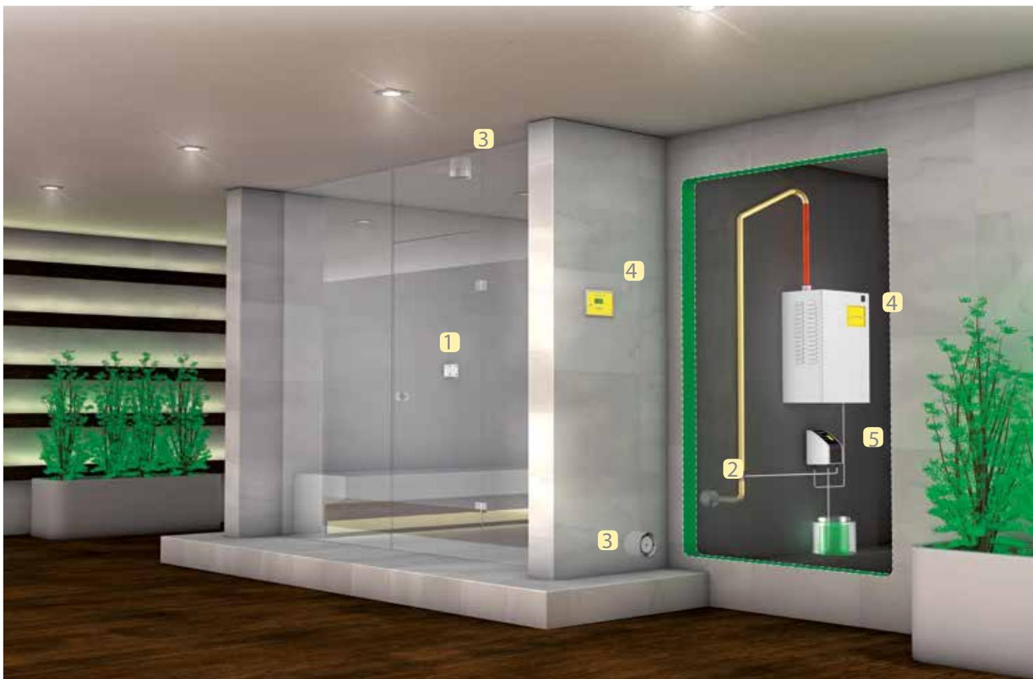
**1** Температурный датчик TF104 для измерения температуры в паровой кабине
